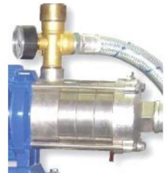
Rys. 5: Wylot pompy wielostopniowej z manometrem do wymiany na przetwornik
