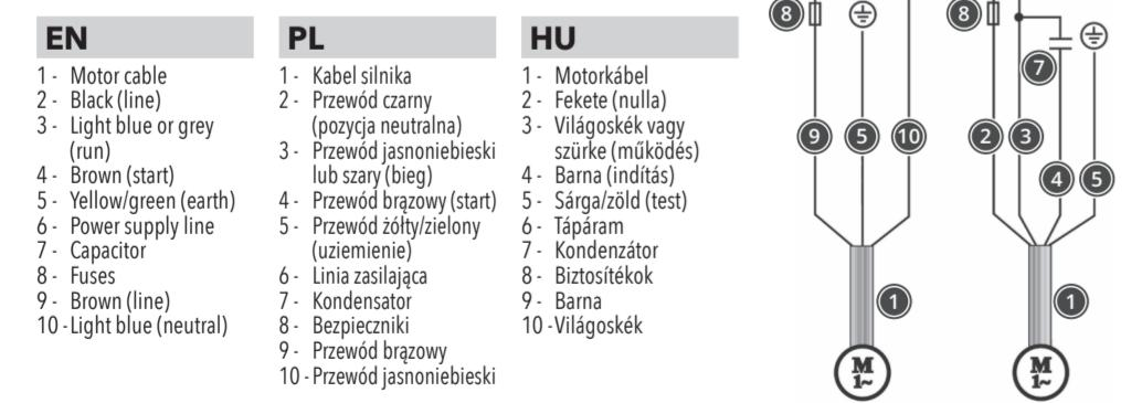
**18** THREE-PHASE MOTOR CONNECTION DIAGRAM - SCHEMAT PODŁĄCZENIA SILNIKA TRÓJFAZOWEGO - HÁROMFÁZISÚ MOTOR BEKÖTÉSI ÁBRA
